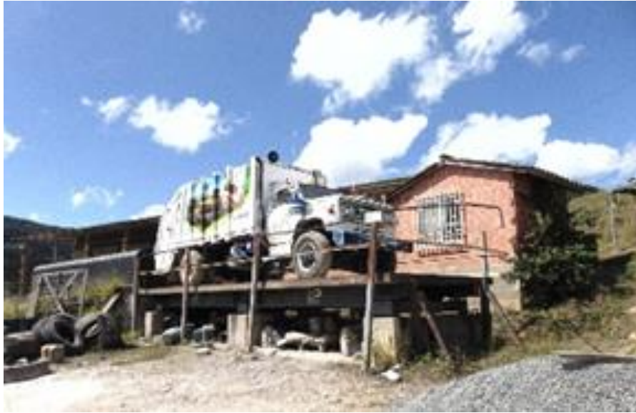
Ilustración 7 Pesaje Vehículo Compactador.
